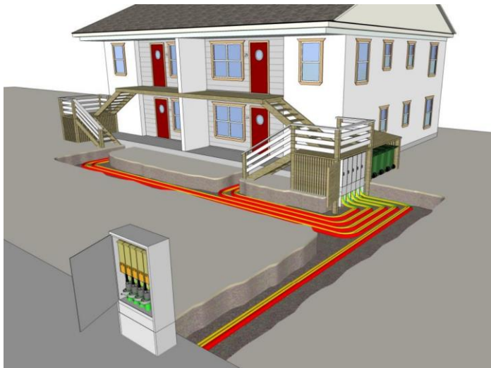
Figur 2 - RT11203 "blokk prinsipp" lavspentfordeling uten etasjefordelere (figur hentet fra RENblad 4100)
